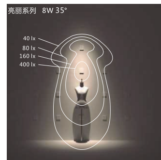
垂直扩展光分布 突出照射垂直的展示物体或柱子。 Vertical spreading light distribution To highlight a vertical display object or pillar.
